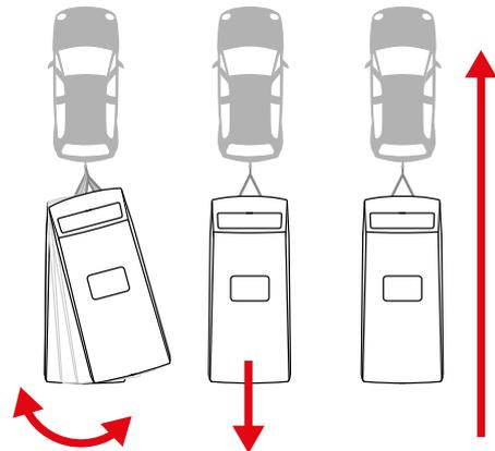
Das Fahrverhalten des Caravan wird vom ATC permanent kontrolliert. Sensoren erfassen gefährliche Seitenbewegungen direkt an der Caravanachse, noch bevor ein im Pkw vorhandenes ESP für Anhänger die Pendelbewegung registrieren kann. Der Caravan wird sofort – ohne Eingreifen des Fahrers – sanft abgebremst und wieder in einen stabilen Fahrzustand gebracht.
