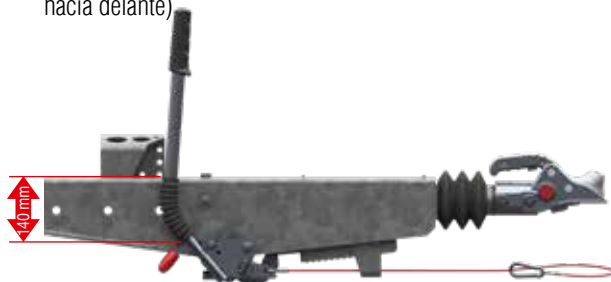
Palanca de freno de mano cerrada (freno de estacionamiento hacia atrás, freno perfectamente ajustado)
