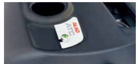
El diodo luminoso en el dispositivo de inercia brilla en rojo de forma permanente. El sistema está en orden de servicio al 100%.
