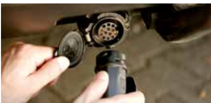
La conexión eléctrica con el turismo se realiza mediante el conector de 13 polos.
