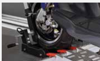
El patín para rueda delantera con fijación del neumático regulable sin escalonamiento, para fijar la rueda delantera fuera del garaje trasero.
