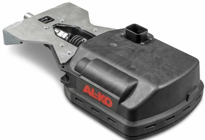
El sistema ATC controla permanentemente el comportamiento de conducción de la caravana. Los sensores registran los movimientos laterales peligrosos directamente en el eje de la caravana, antes incluso de que un ESP para remolques instalado en el automóvil pueda registrar el movimiento de oscilación. La caravana se frena suavemente de inmediato sin que intervenga el conductor y vuelve a un estado de marcha estable.
