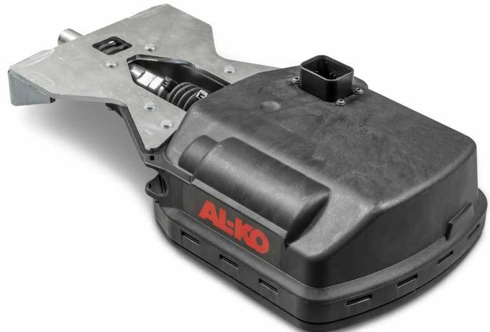
Il comportamento di guida della caravan è controllato in modo permanente da ATC. I sensori rilevano movimenti laterali pericolosi direttamente sull'assale della caravan ancora prima che l'ESP per i rimorchi registri il movimento di oscillazione. La caravan frena subito e delicatamente, senza l'intervento del conducente e ritorna in condizioni di guida stabili.
