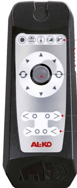
Pannello di controllo con display della batteria (caravan/telecomando) e sovraccarico
