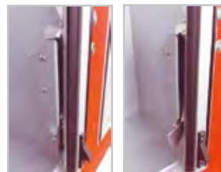
Tegenhouder 2552.4050.2010 op een rail bij de stangsluiting.
